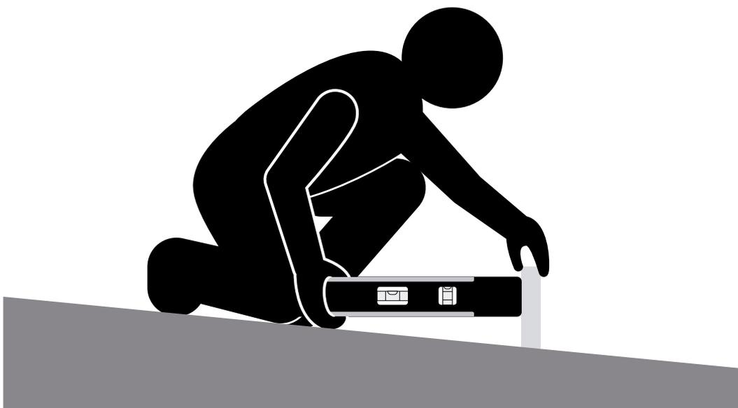
**Ilustración 3.2.** Colocación del nivel para medir una rampa.
